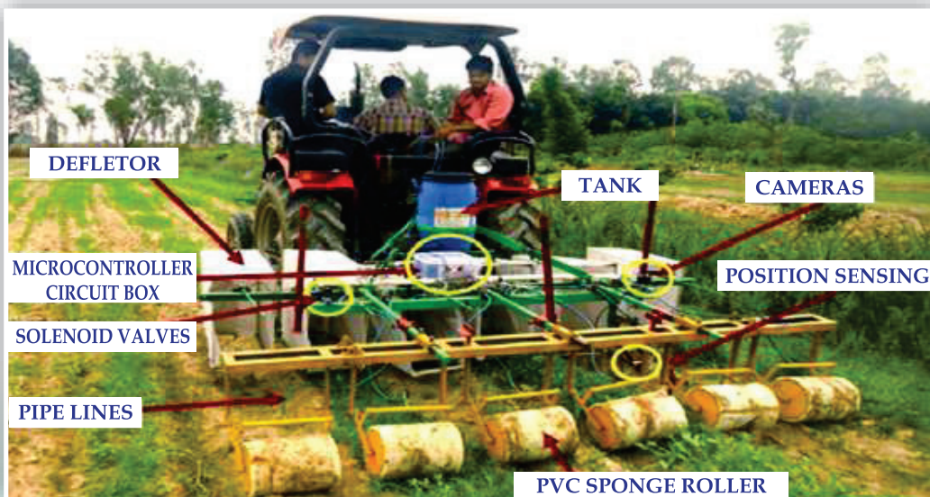
चित्र-2: ट्रैक्टर चालित कांटेक्ट स्पॉन्ज रोलर टाइप खरपतवार नियंत्रण मशीन
