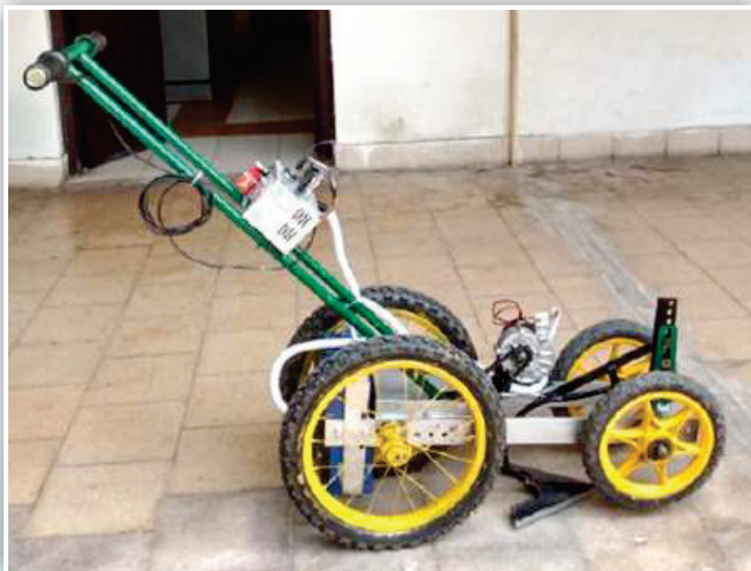
चित्र-1: मानव निर्देशित बैटरी चालित चौपहिया खरपतवार नियंत्रण मशीन
